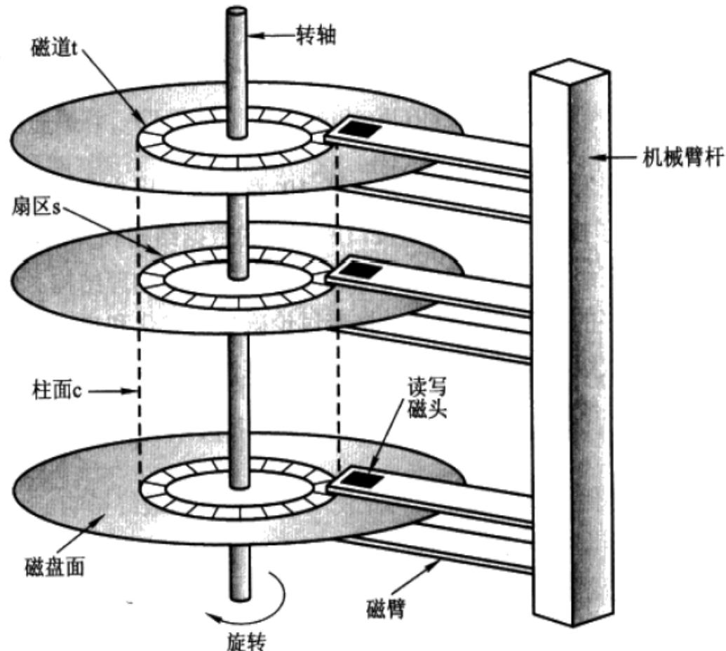
为了访问磁盘上的一个物理记录，必须给出三个参数：**<柱面号, 磁头号, 扇区号>**
